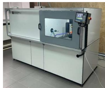
Рис. 1. Схема (а) и внешний вид установки LS85 (б) для проведения процесса лазерной ударной обработки
