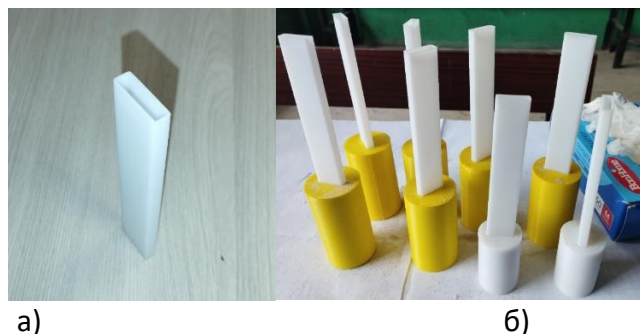
Рис. 1. Формы для керамических стержней а) растворяемая оболочка; б) оболочка, установленная на инфильтрационную подложку
