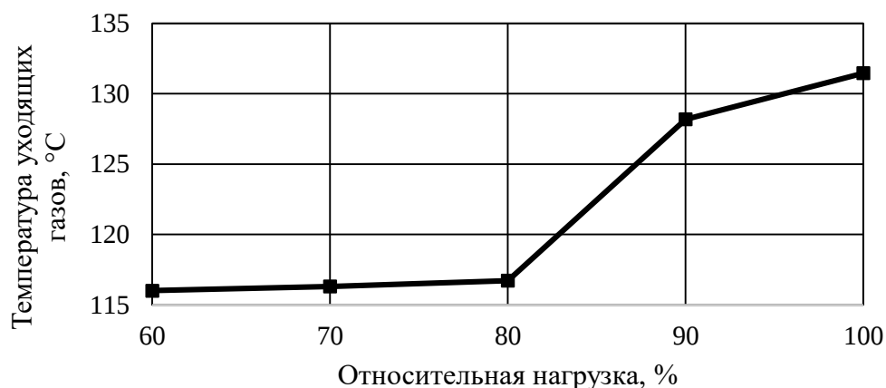
Рис. 3. Зависимость температуры уходящих газов от нагрузки
