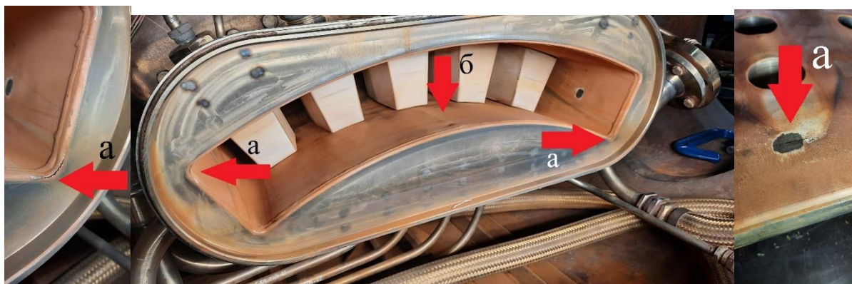
Рис.3 – Дефекты в узле мерный участок: а – трещины; б – деформация.
