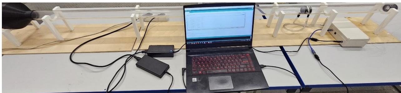
Рис. 3. Установка для измерения падения давления на образце
